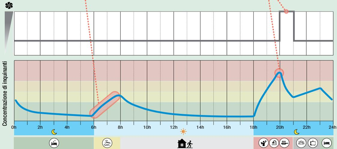
Impostando una schedulazione oraria, la regolazione è automatizzata in funzione delle abitudini domestiche e permette mediamente una buona qualità dell'aria.
